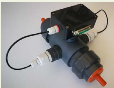
Abb.2: Sensoreinheit mit montiertem Gehäuse für die Elektronikbaugruppen. Die Grafik zeigt die Messergebnisse für Wasserproben mit unterschiedlichen Schwebstoffanteilen.
