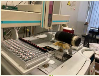
Abb1: Gaschromatograph (GC)/Massenspektrometer (MS). Das Diagramm zeigt ein Totalionenchromatogramm eines Klärwasserextraktes mit zugesetztem Diclofenac.
